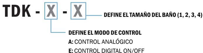
**A modo de ejemplo:** si usted adquiere un **TDK-E-2**, esto significa que se trata de un baño termostático con *control de temperatura digital On-Off*, de 6 litros de volumen, con 2 gradillas y con una potencia eléctrica de 350 watts.
