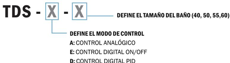
A modo de ejemplo: si usted posee un **TDS-E-55**, esto significa que se trata de un baño con sobrepeso con *control de temperatura digital On-Off*, de un volumen de 19 litros y de 1500 watts de potencia.
