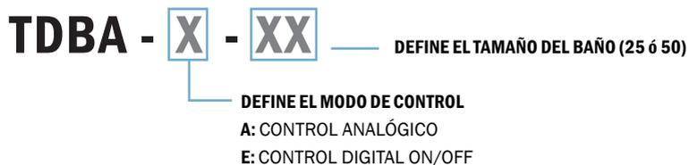
**A modo de ejemplo:** si usted adquiere un **TDBA-E-25**, esto significa que se trata de un baño de arena con control de temperatura *digital On-Off*, de un volumen de 3,6 litros y de 300 watts de potencia.
