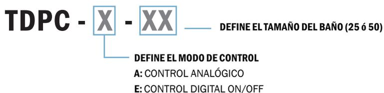
**A modo de ejemplo:** si usted adquiere un **TDPC-E-25**, esto significa que se trata de una plancha calefactora con control de temperatura *digital On-Off*, de una superficie térmica de 729 cm<sup>2</sup> y de 300 watts de potencia.
